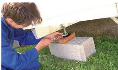
Finaliser le réglage grâce aux vérins à l'aide d'une clef à molette.
